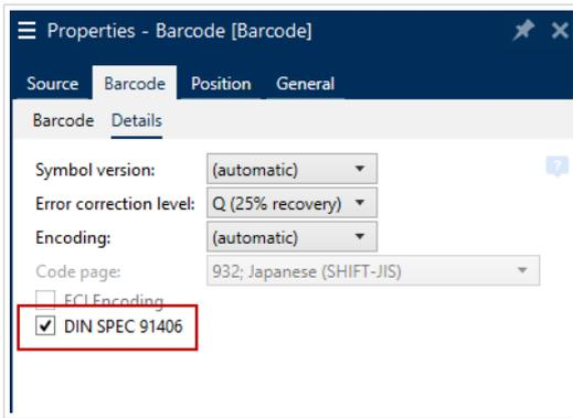
DIN SPEC 91406 设置围着二维码和数据矩阵条形码增加了安静区和边框。边框右下角有一个黑色的三角。边框不影响条形码的读取。
